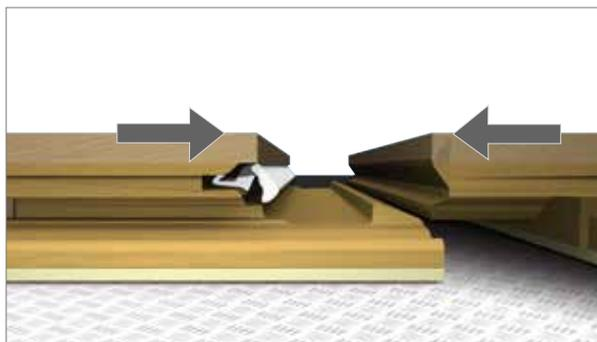
Quick-Step 实木复合地板也可水平插入，但与其他厂家的地板相比，操作略有不同。安装最后一排地板时，以及在很难或无法倾斜安装地板的位置（如门框或暖气片下），这样操作方便易行。
